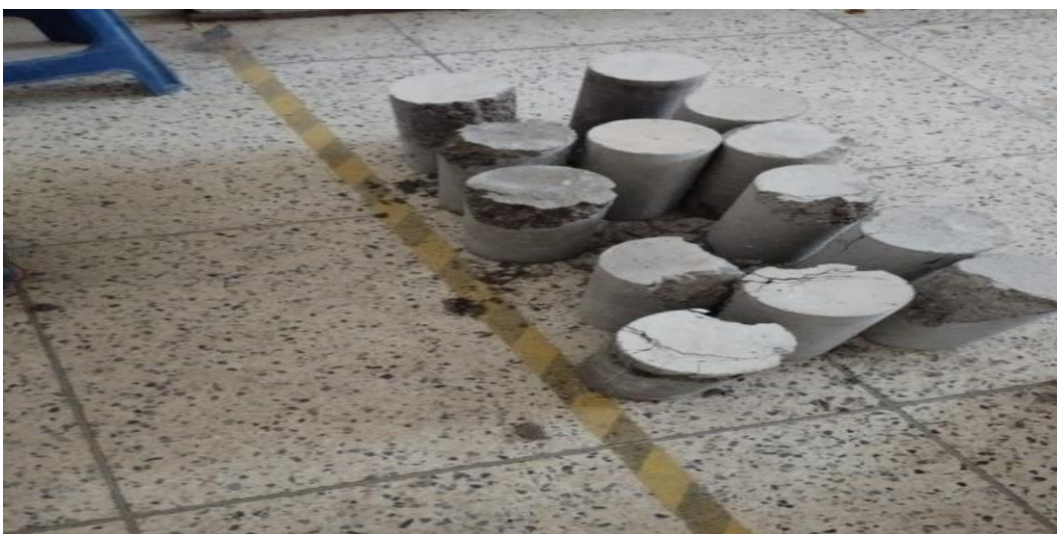
Nota: Briquetas ya roturadas.
