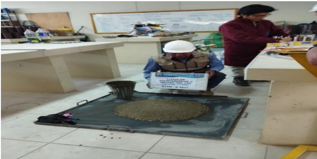
Nota: Optimo de mezcla con 2.0% de aditivo.
