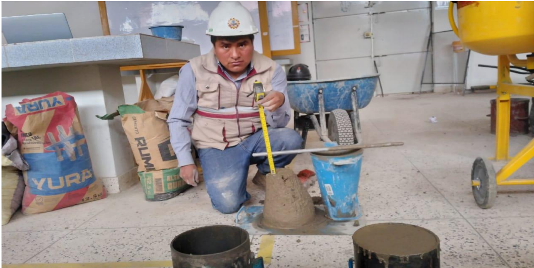
Nota: Slump del concreto patrón.
