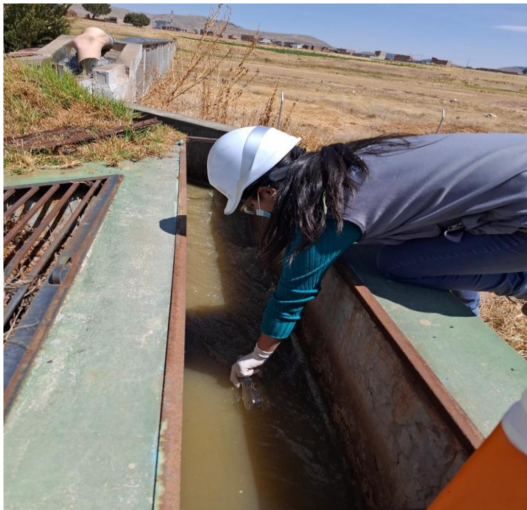
muestras en la entrada de la PTAR de acuerdo a los parametros a evaluar
