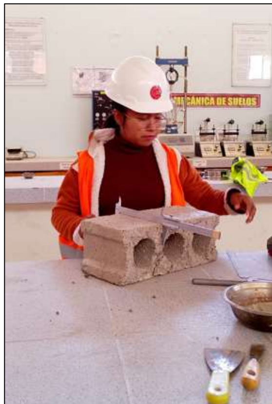
Fotografía N° 12: Medida de la variación dimensional
