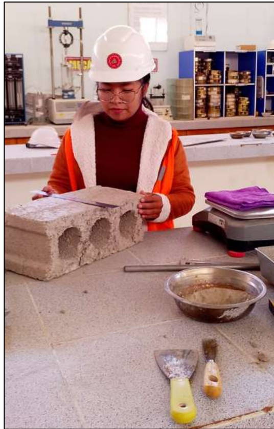
Fotografía N° 07: Medición de la variación del bloque de concreto
