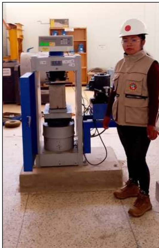
Fotografía N° 16: Ensayo de resistencia a la compresión
