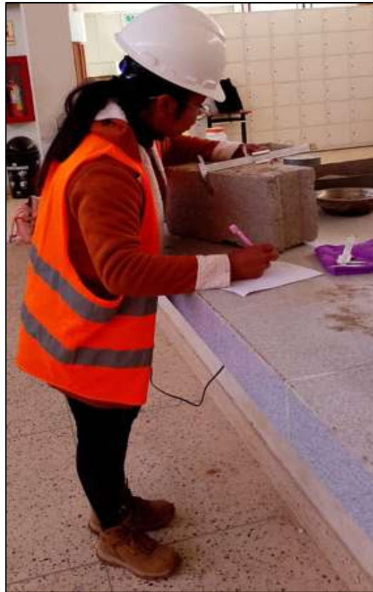
Fotografía N° 13: Medida de la variación dimensional
