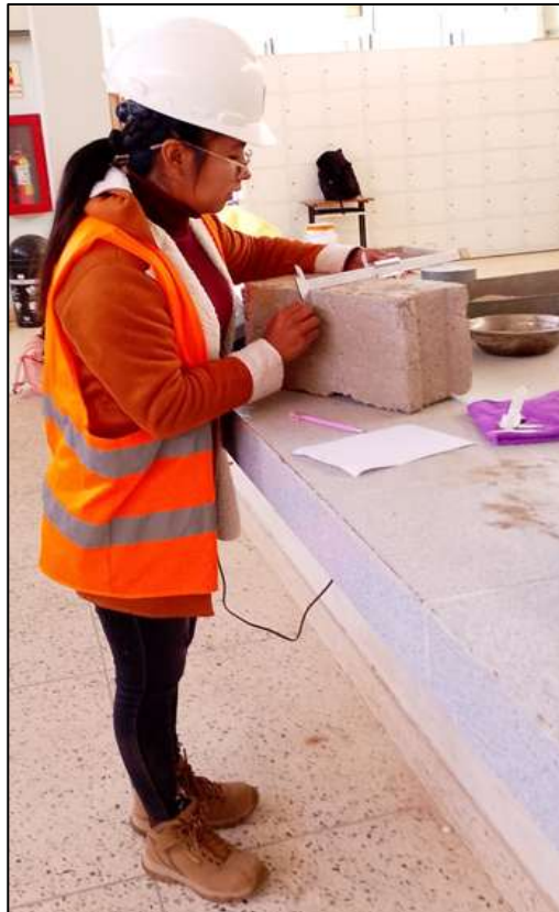
Fotografía N° 11: Medida de la variación dimensional
