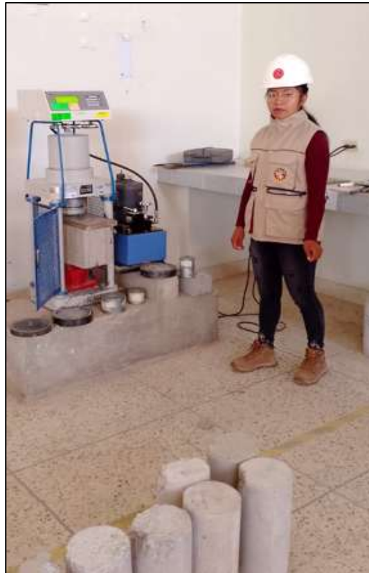
Fotografía N° 15: Ensayo de resistencia a la compresión
