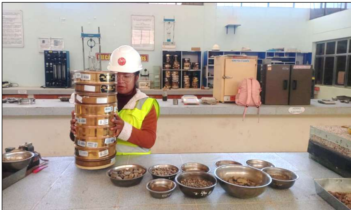
Fotografía N° 02: Tamizado de la muestra
