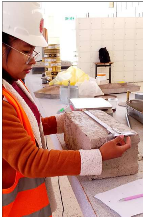
Fotografía N° 06: Medición de la variación del bloque de concreto
