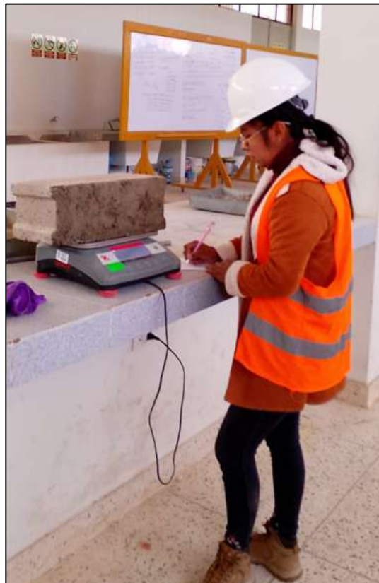
Fotografía N° 08: Pesado de muestra del bloque de concreto
