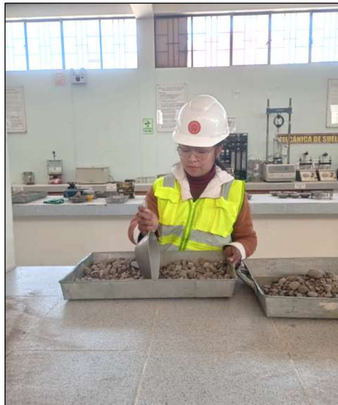
Fotografía N° 01: Cuarteo de muestra
