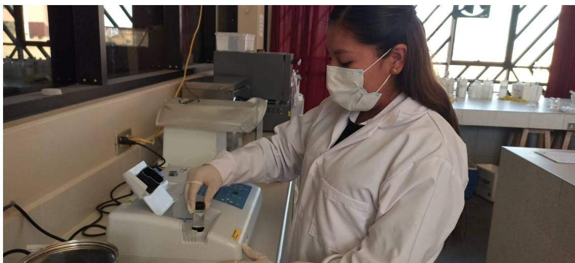
Fotografía 6. Medición de la turbiedad del recurso hídrico en la isla Amantani del departamento de Puno.
