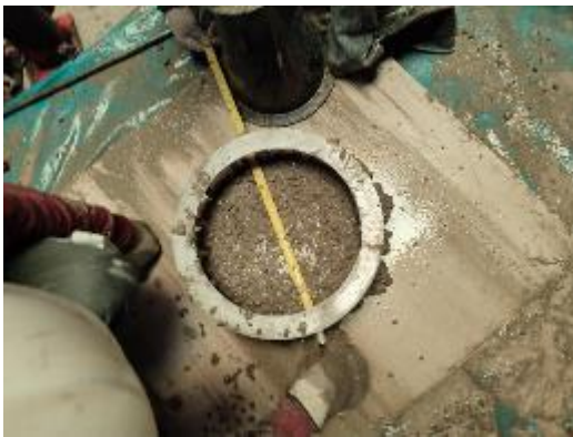
Fotografía 3. Ensayo J Ring tiempo de mezcla 90 minutos.
