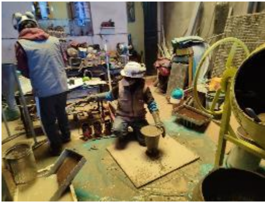
Fotografía 1. Ensayo Extensión de Flujo.
