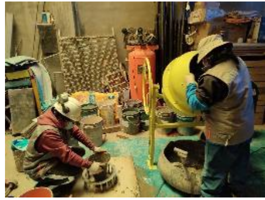
Fotografía 2. Ensayo J Ring.
