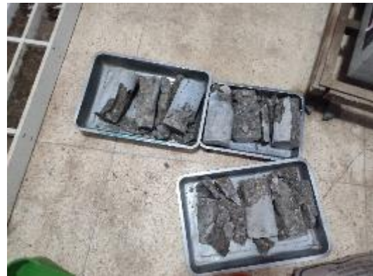
Fotografía 1. Clasificación de Tipo de falla de Briquetas
