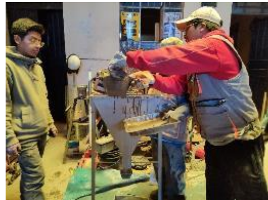
Fotografía 4. Ensayo Embudo en V.
