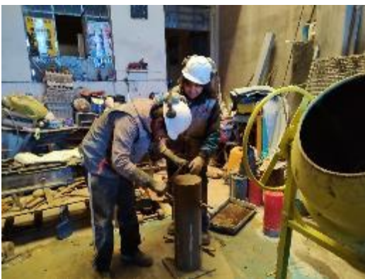
Fotografía 3. Ensayo J Ring tiempo de mezcla 90 minutos.
