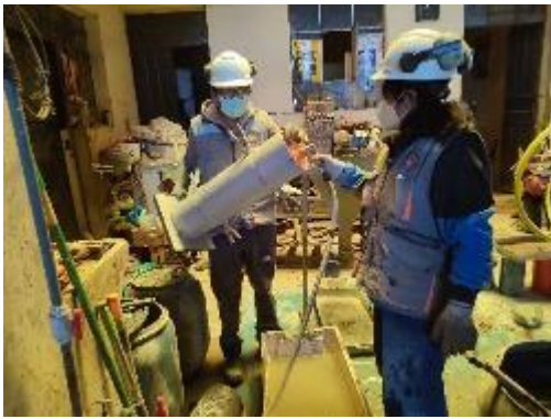
Fotografía 9. Ensayo Columna de Segregación humedecido.
