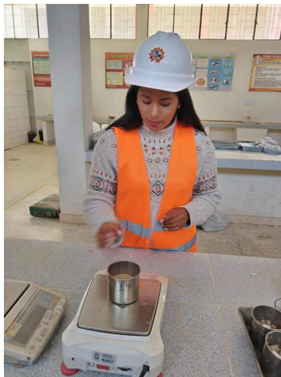
Fotografía 6. Ensayo de capacidad de soporte CBR en muestra de suelo natural
