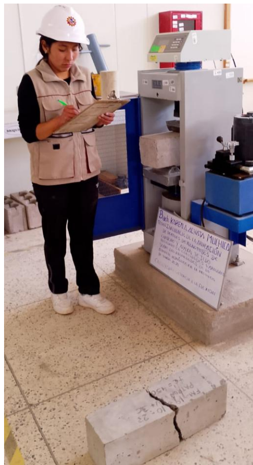
Fotografía 18. Rotura de viguetas de concreto hidráulico en prensa hidráulica
