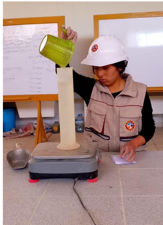
Fotografía 6. Mezcla de agua con agregados
