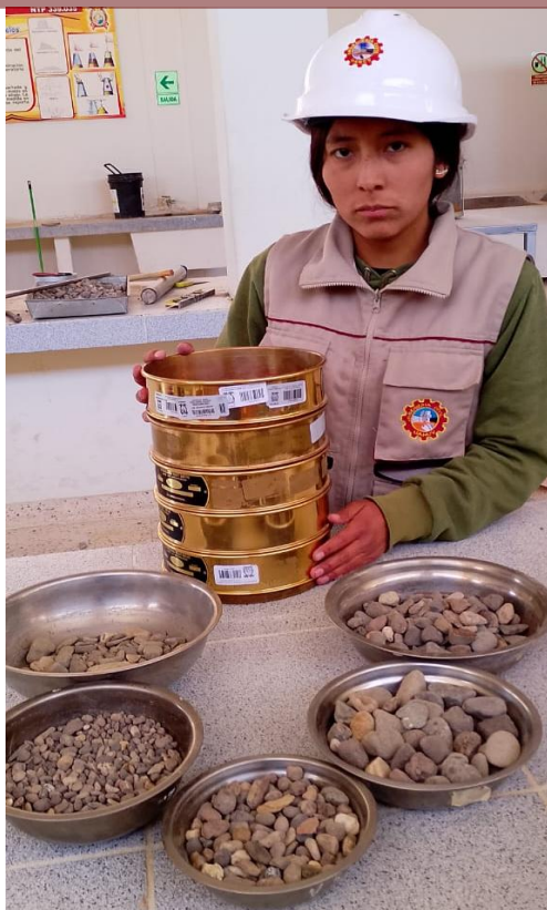
Fotografía 1. Análisis granulométrico de agregados
