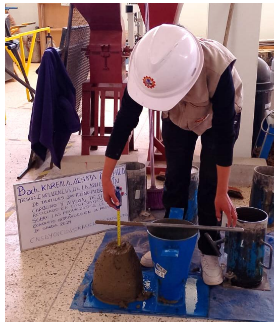
Fotografía 10. Medición del asentamiento del concreto hidráulico en su estado fresco
