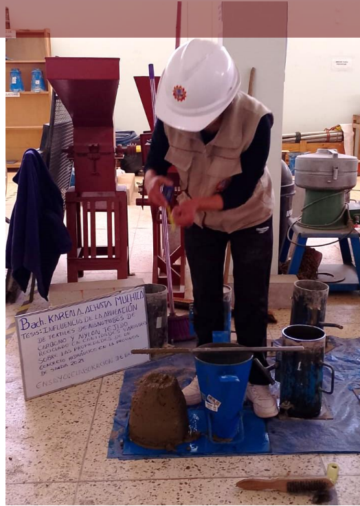
Fotografía 11. Medición del asentamiento de la mezcla con nylon tejido reciclado
