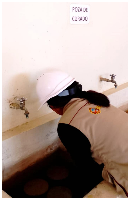
Fotografía 14. Proceso de curado de briquetas
