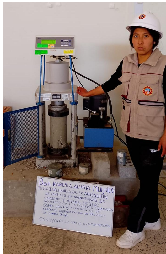
Fotografía 16. Rotura de briquetas de concreto hidráulico en prensa hidráulica
