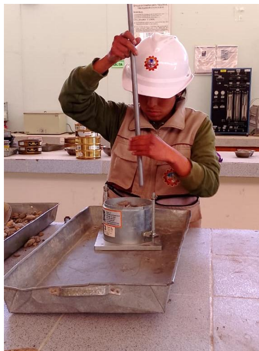
Fotografía 4. Varillado de material para determinación de pesos unitarios
