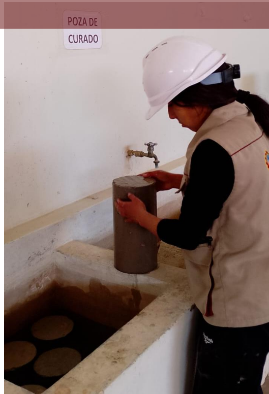
Fotografía 13. Desmolde de briquetas para su posterior curado
