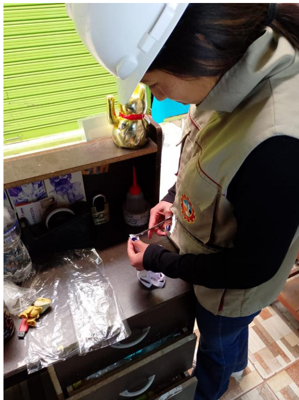
Fotografía 20. Corte de textiles de nanotubos de carbono en tiras de 0.5 cm a 1.0 cm.
