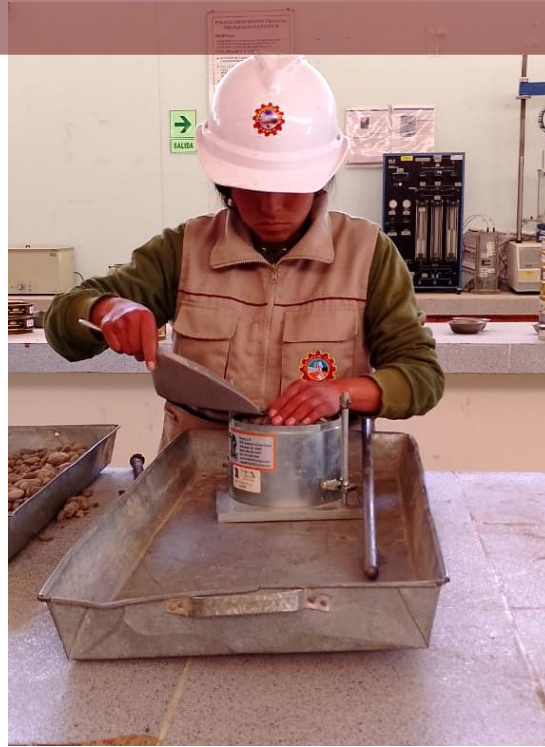
Fotografía 5. Llenado de agregados para varillado y enrasado
