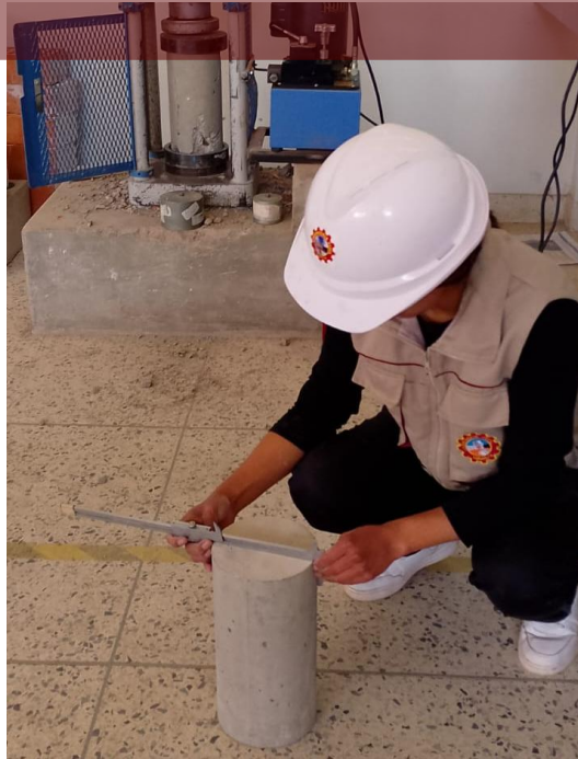
Fotografía 15. Medición de briquetas para su posterior rotura
