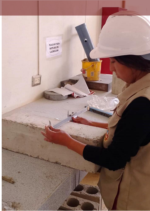
Fotografía 17. Medición de viguetas para su posterior rotura
