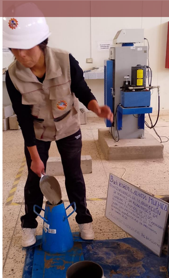
Fotografía 9. Colocado de mezcla fresca al cono de Abrams para determinación del Slump
