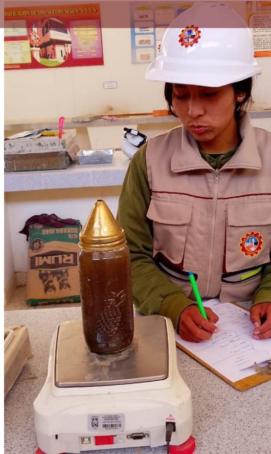
Fotografía 3. Pesaje de picnómetro para ensayo de pesos específicos
