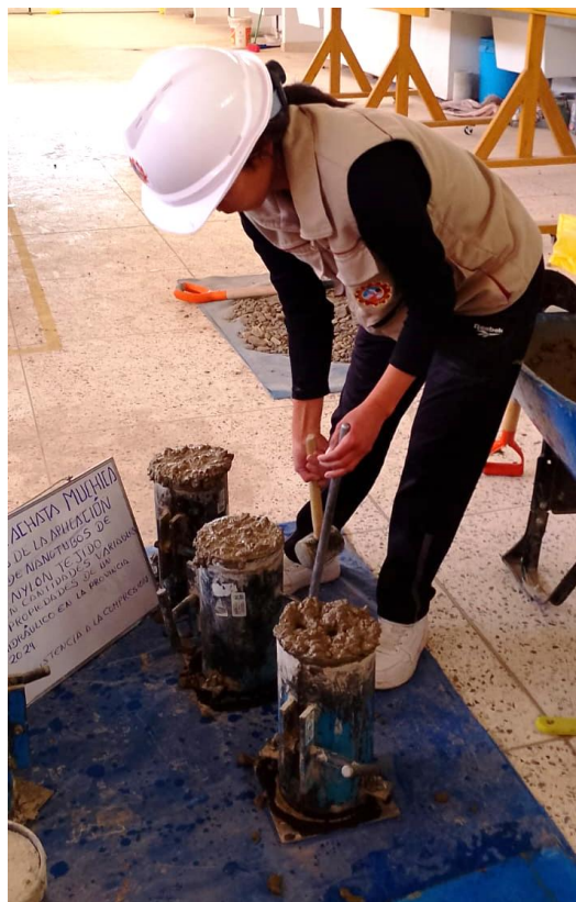
Fotografía 12. Colocado y varillado de mezcla fresca en moldes de briqueta
