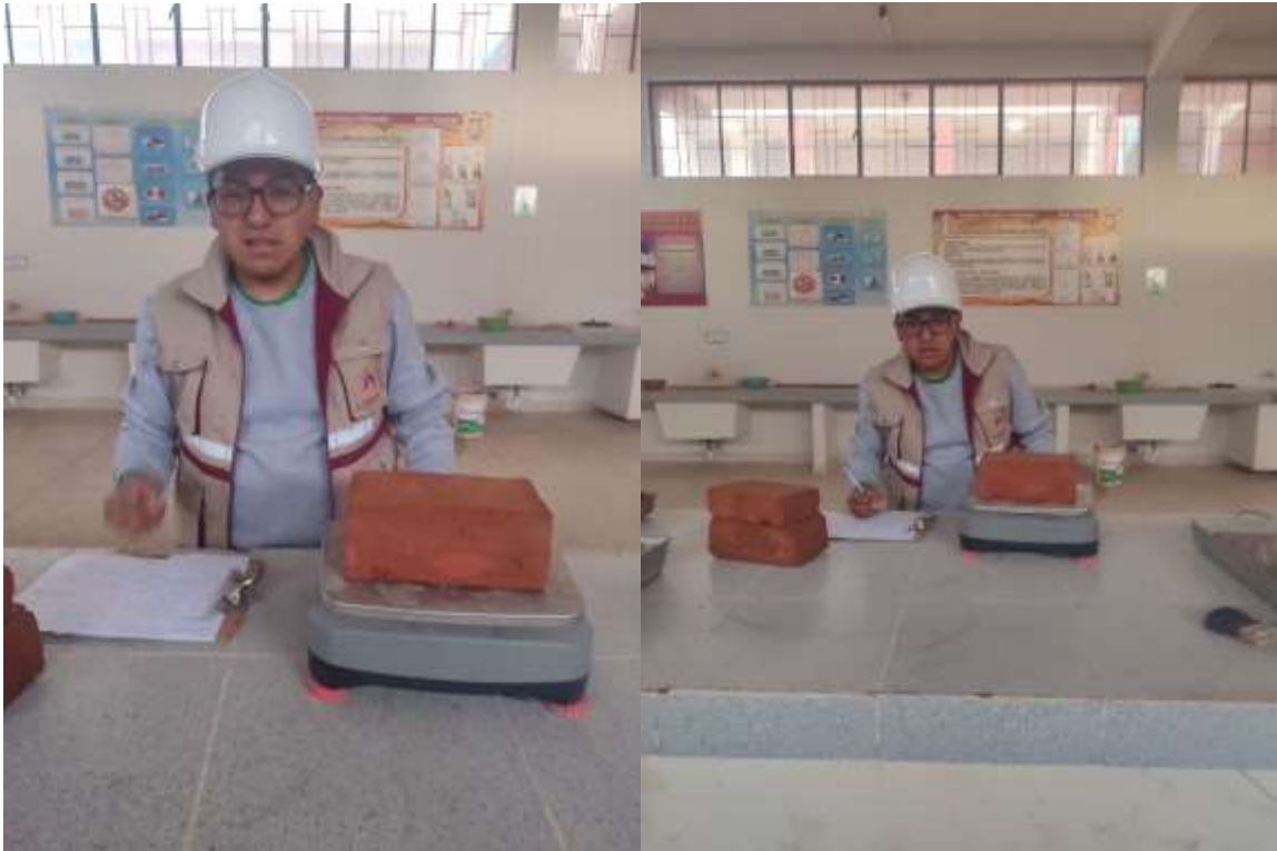
Fotografía 1. Succión del ladrillo
