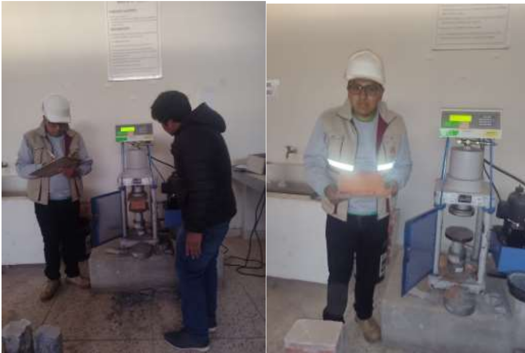
Fotografía 3. Resistencia a compresión del ladrillo
