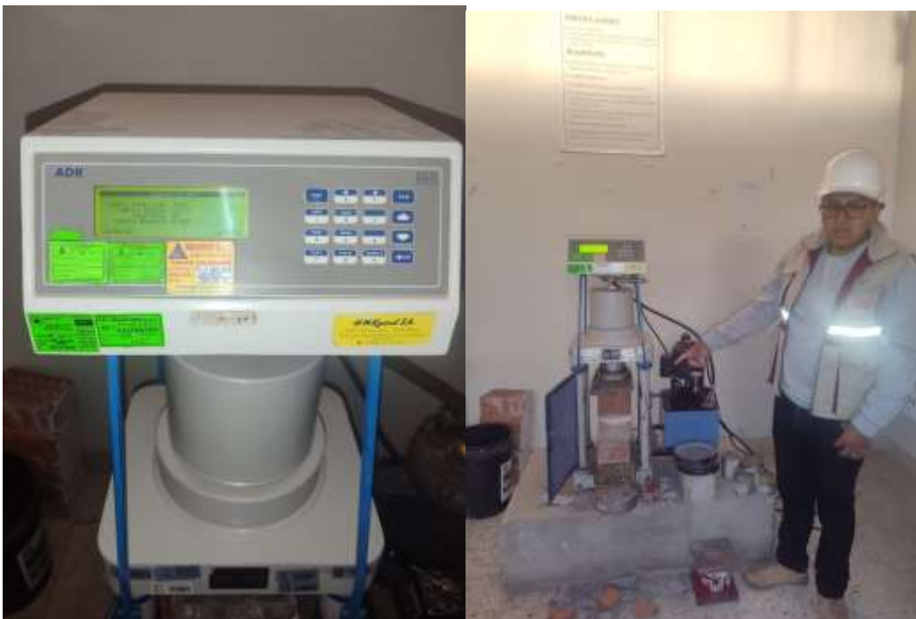
Fotografía 4. Resistencia de pilas
