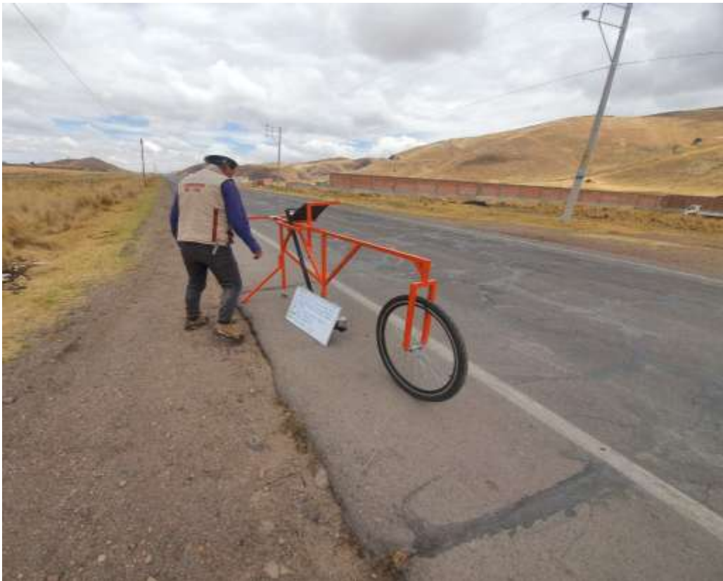
Fotografía 7. Rugosidad en el tramo 4 +400 km
