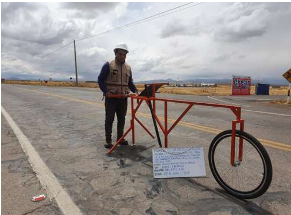
Fotografía 2. Rugosidad en el tramo 4 +400 km
