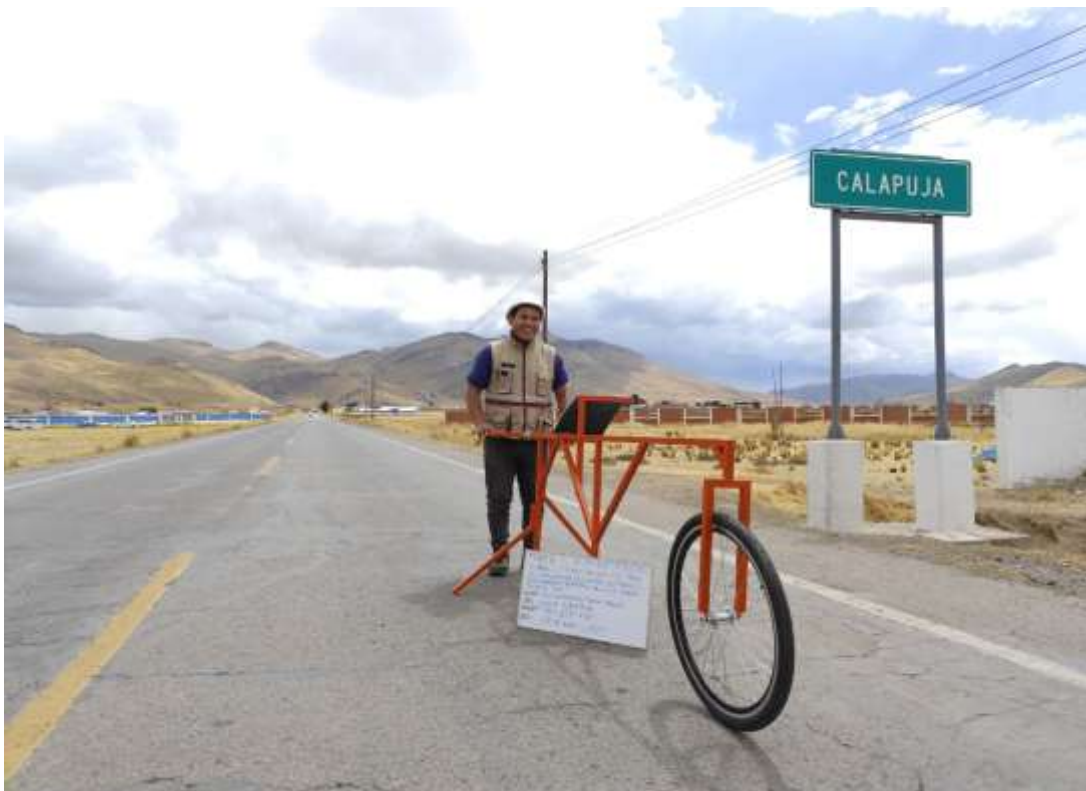
Fotografía 4. Rugosidad en el tramo 5 +800 km carril derecho
