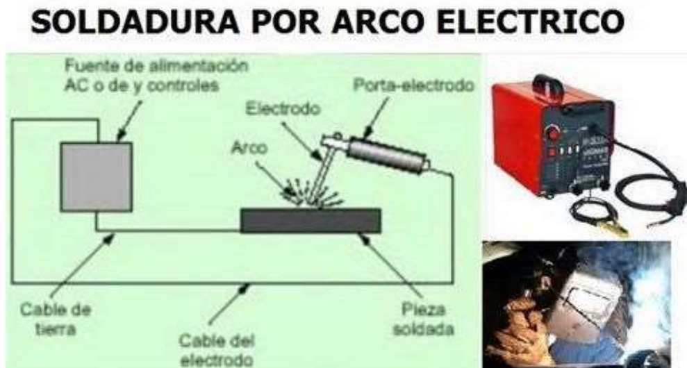
Figura 1. Soldadura por arco
