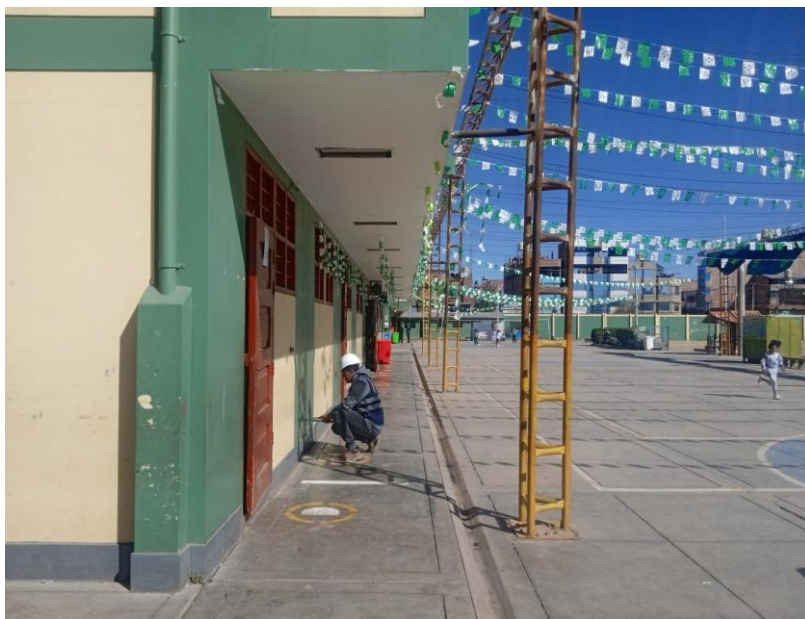
Fotografía 3. Vista fotográfica sobre la elaboración de ensayo de esclerómetro en columna.
