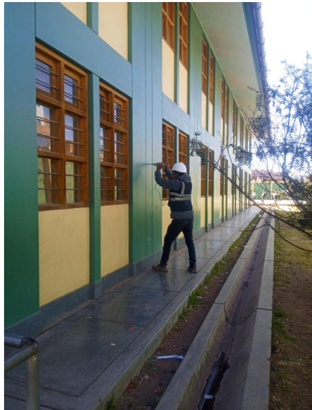
Fotografía 3. Vista fotográfica sobre la elaboración de ensayo de esclerómetro en columna.
