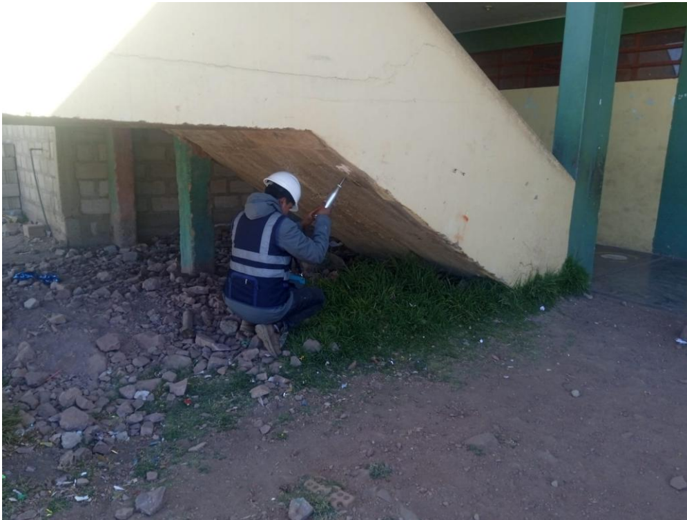
Fotografía 7. Vista fotográfica sobre la elaboración de ensayo de esclerómetro en el tramo de la escalera.
