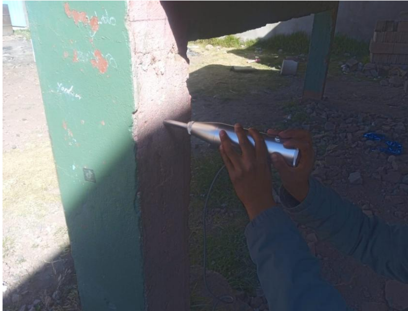
Fotografía 5. Vista fotográfica sobre la elaboración de ensayo de esclerómetro en las columnas de la escalera.
