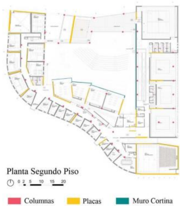
Figura 22: Estructuración De La Escuela
