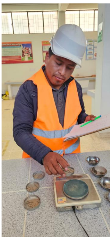
Fotografía 8. Pesado de la muestra de limite plástico.
