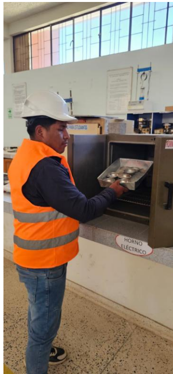
Fotografía 9. Colocación de muestra en el horno.
