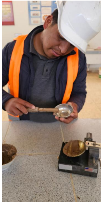
Fotografía 1. Elaboración de ensayo en la cuchara de Casagrande
