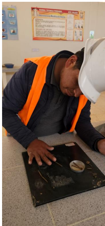
Fotografía 2. Elaboración de ensayo limite plástico.
