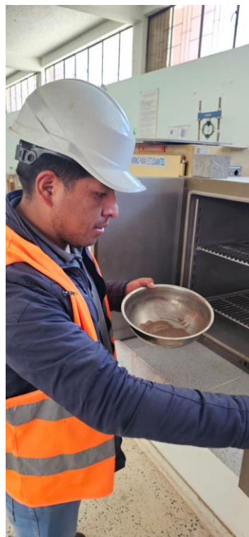
Fotografía 4. Colocación de muestras en el horno para el secado.
