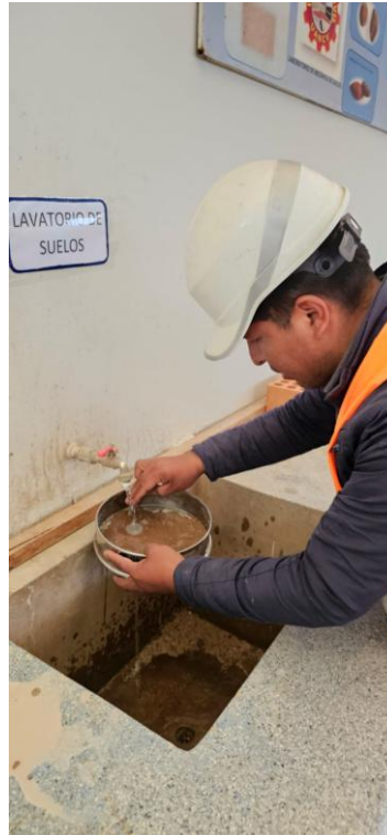
Fotografía 3. Lavado de muestra de suelo.
