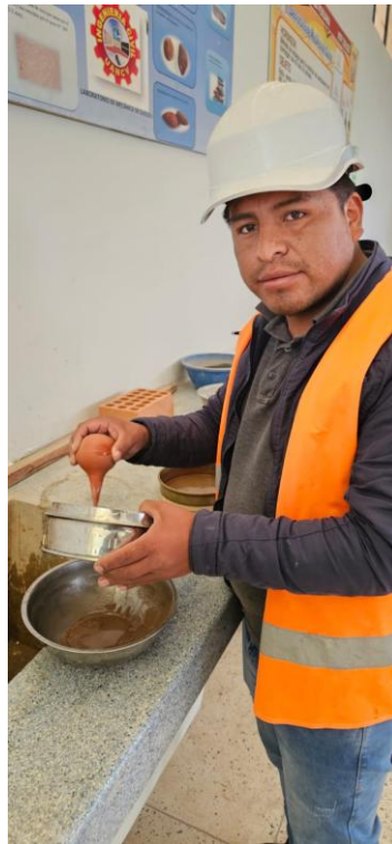
Fotografía 5. Proceso de lavado del tamiz
