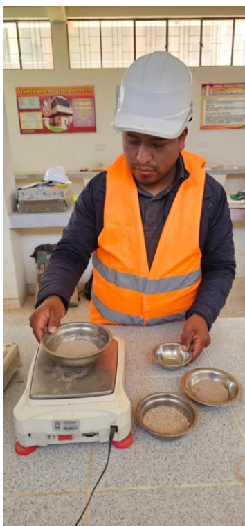
Fotografía 7. Proceso del pesado de las muestras luego del secado
