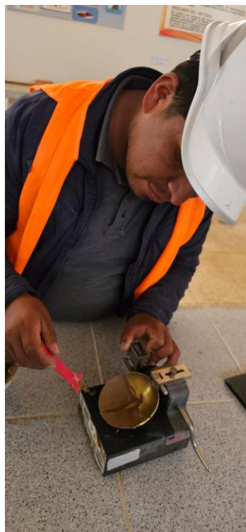
Fotografía 10. Proceso de elaboración del ensayo de límite líquido.
