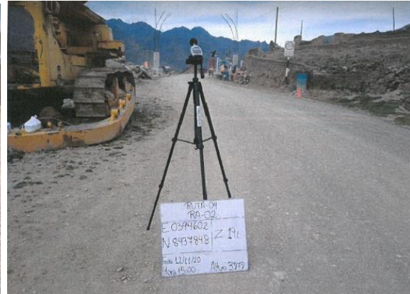
Fotografía N° 04: 1ra Estación de Ruido Ambiental (RA-02) - Mejoramiento
