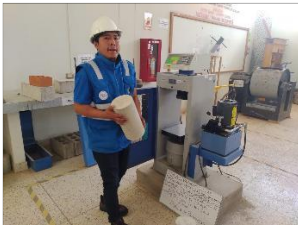
Fotografía 24. Probeta de concreto para prueba de compresión mecánica.
