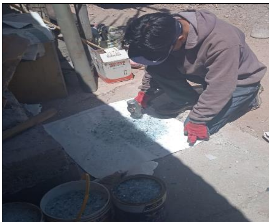
Fotografía 2. Trituración de vidrio reciclado.
