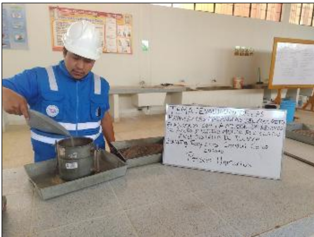
Fotografía 17. Muestra de agredo para prueba de compactación.
