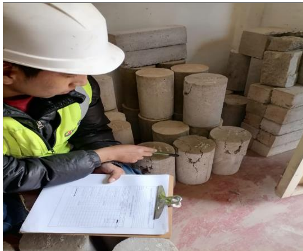
Fotografía 28. Probetas de concreto luego de sometidas a pruebas de compresión.
