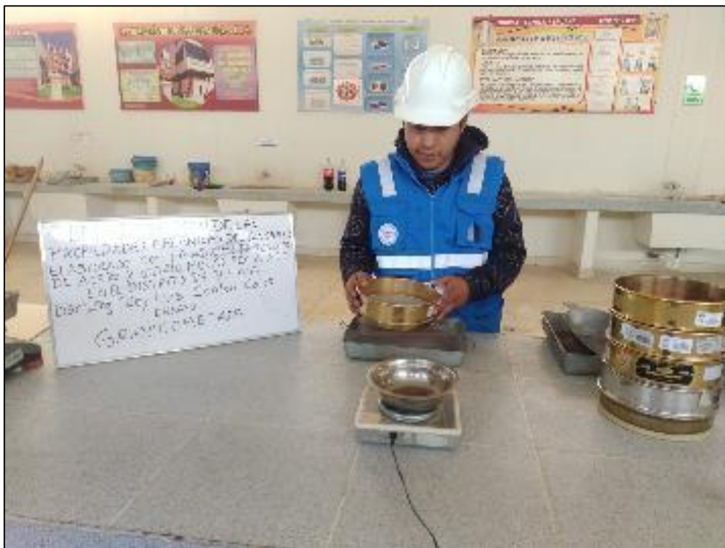
Fotografía 8. Registro de datos de los pesos retenidos en los tamices.
