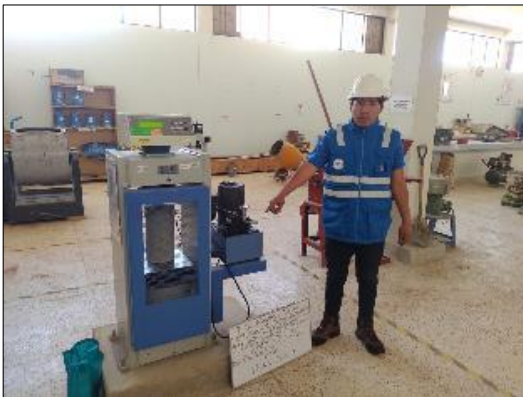
Fotografía 23. Equipo para ensayo de resistencia a la compresión.
