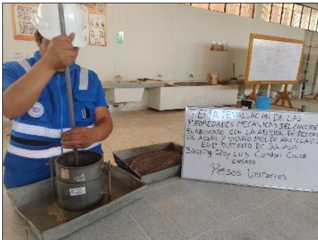
Fotografía 19. Prueba de compactación para el agregado grueso.
