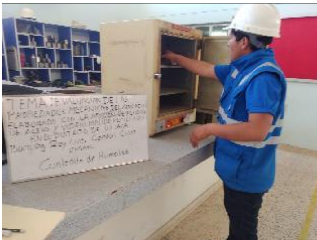
Fotografía 12. Colocación de la muestra para el secado en horno.
