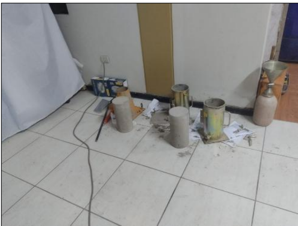
Fotografía 22. Muestra de testigos de concreto.
