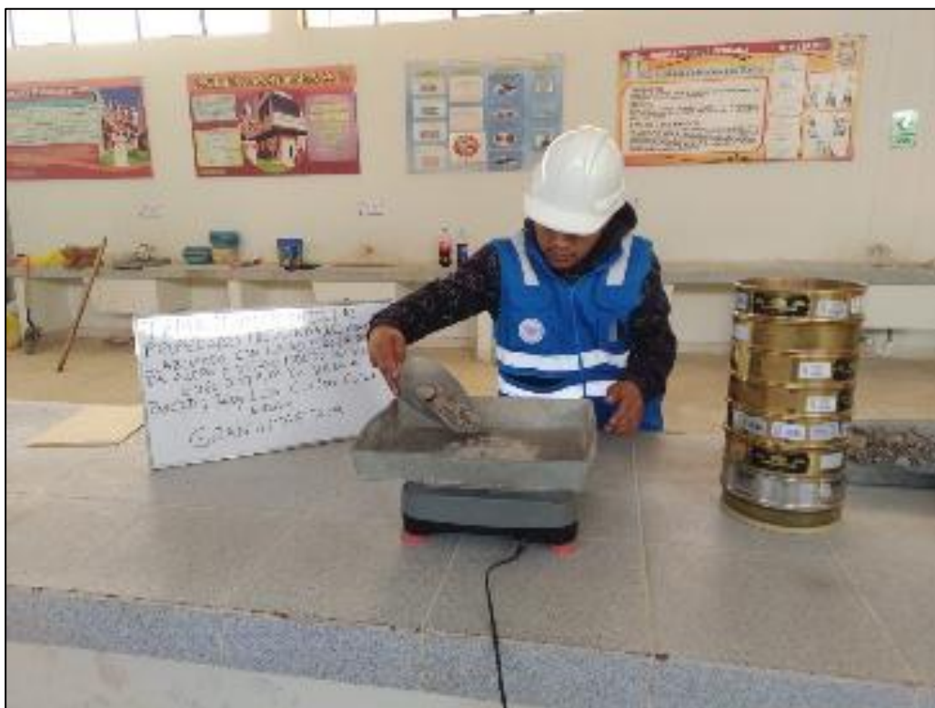
Fotografía 3. Peso del agregado para el ensayo granulométrico.
