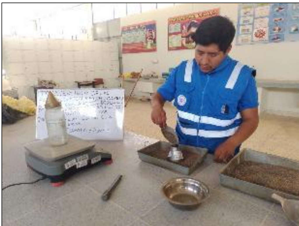
Fotografía 9. Prueba de densidad de agregados finos.
