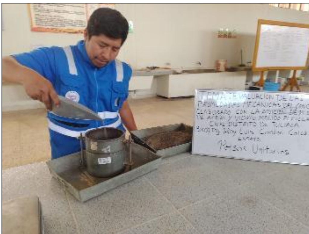
Fotografía 16. Colocación del agregado fino al molde.
