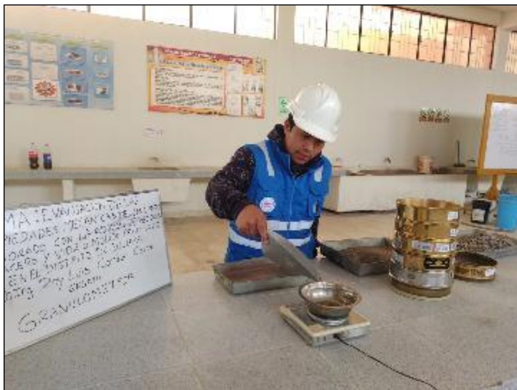
Fotografía 7. Peso de retenido en los tamices del agregado fino.
