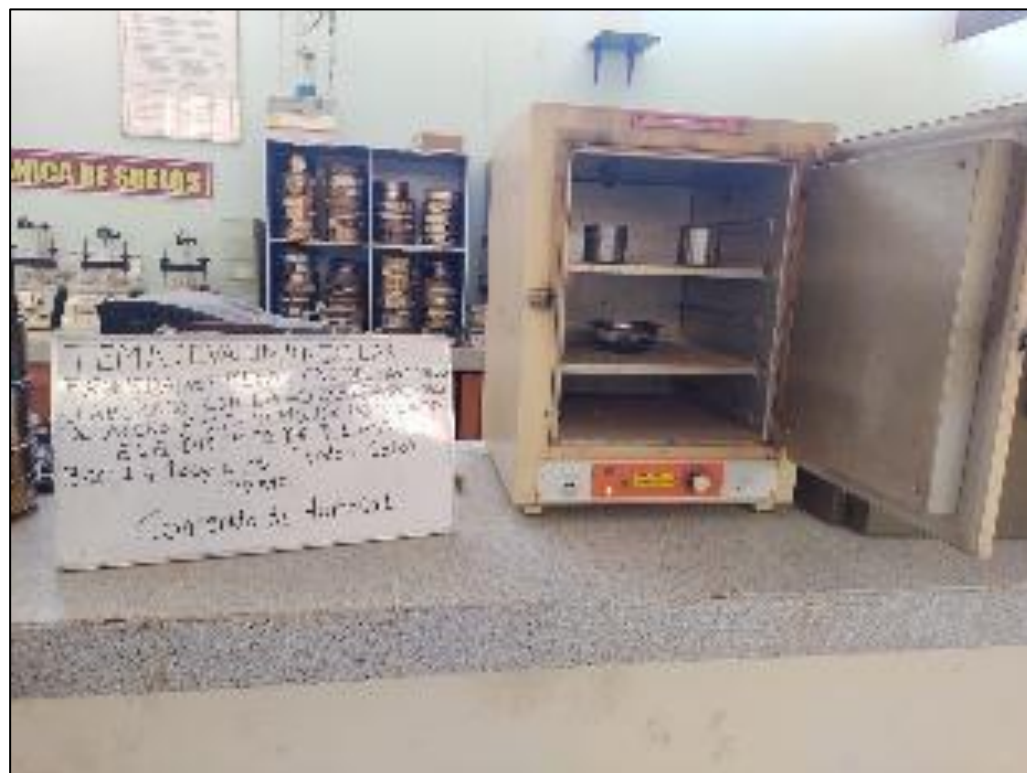
Fotografía 14. Muestras sometidas al secado en horno.
