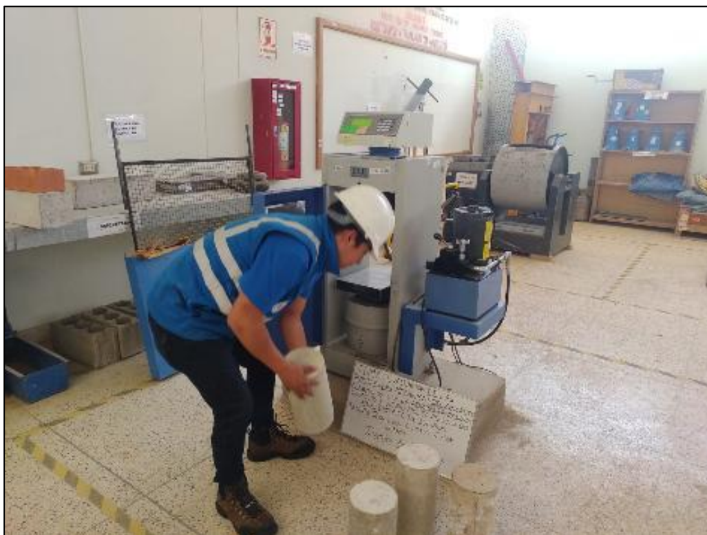
Fotografía 26. Retiro de la probeta de concreto del equipo de compresión.
