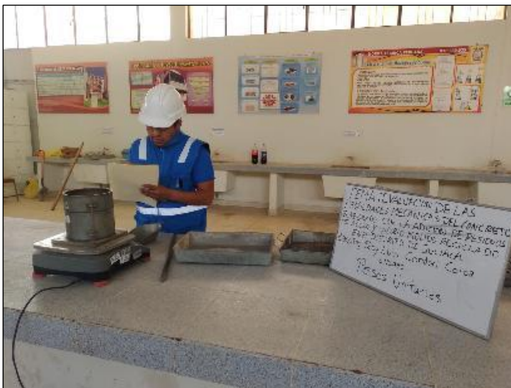
Fotografía 20. Registro del peso del molde más el agregado grueso.
