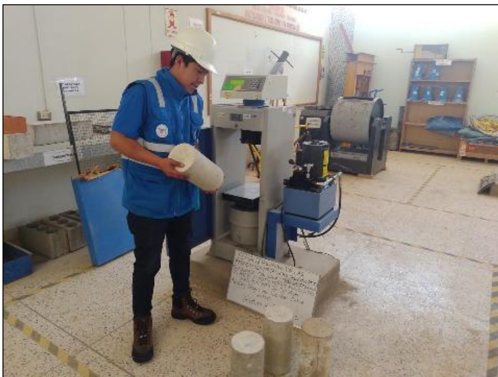
Fotografía 25. Colocación de la probeta de concreto al equipo de compresión.
