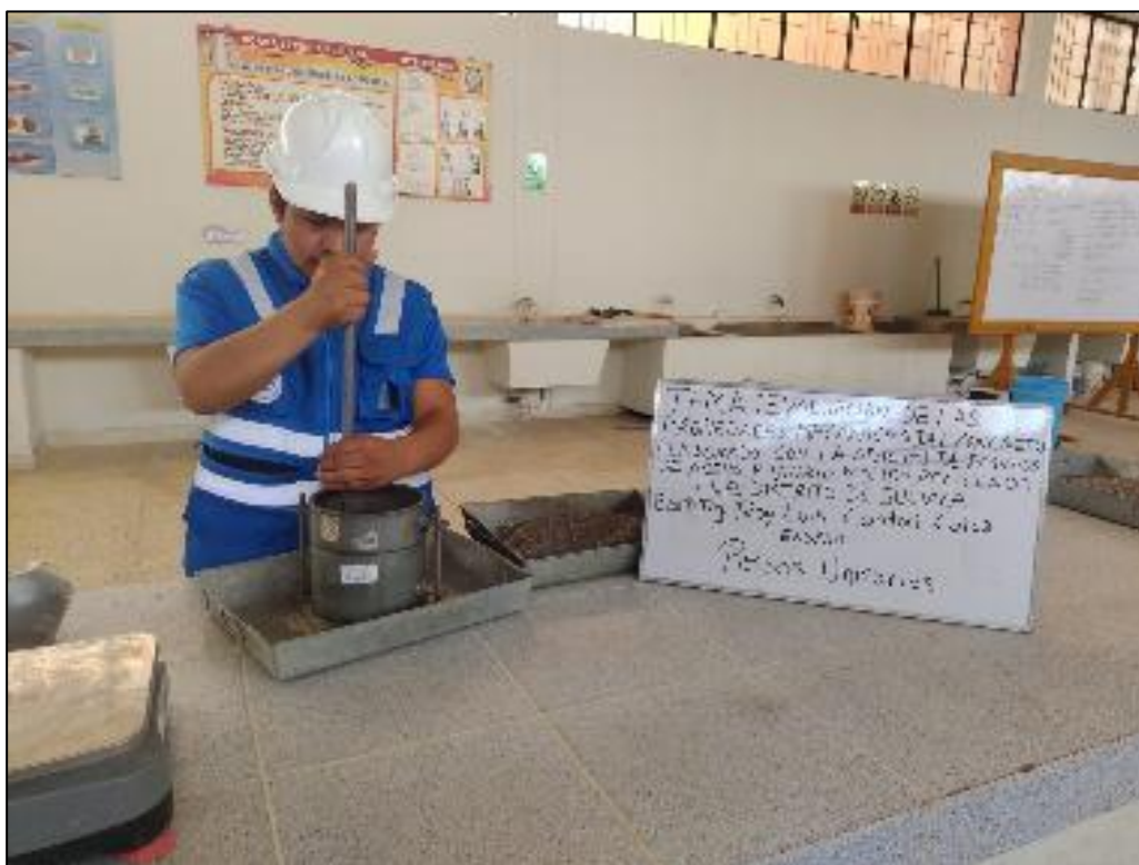
Fotografía 18. Proceso del varillado del agredo fino.
