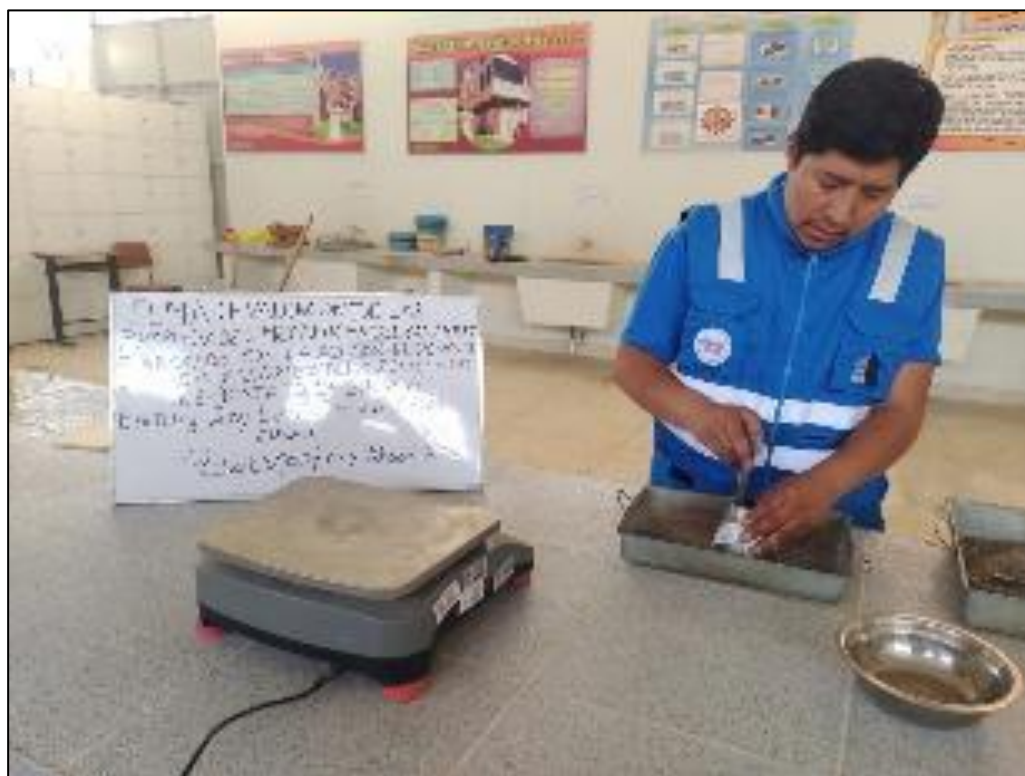
Fotografía 10. Determinación de la absorción de agregados finos.
