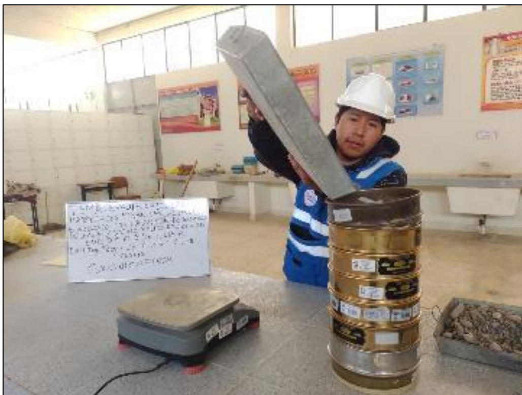
Fotografía 4. Colocación de la muestra para el ensayo granulométrico.
