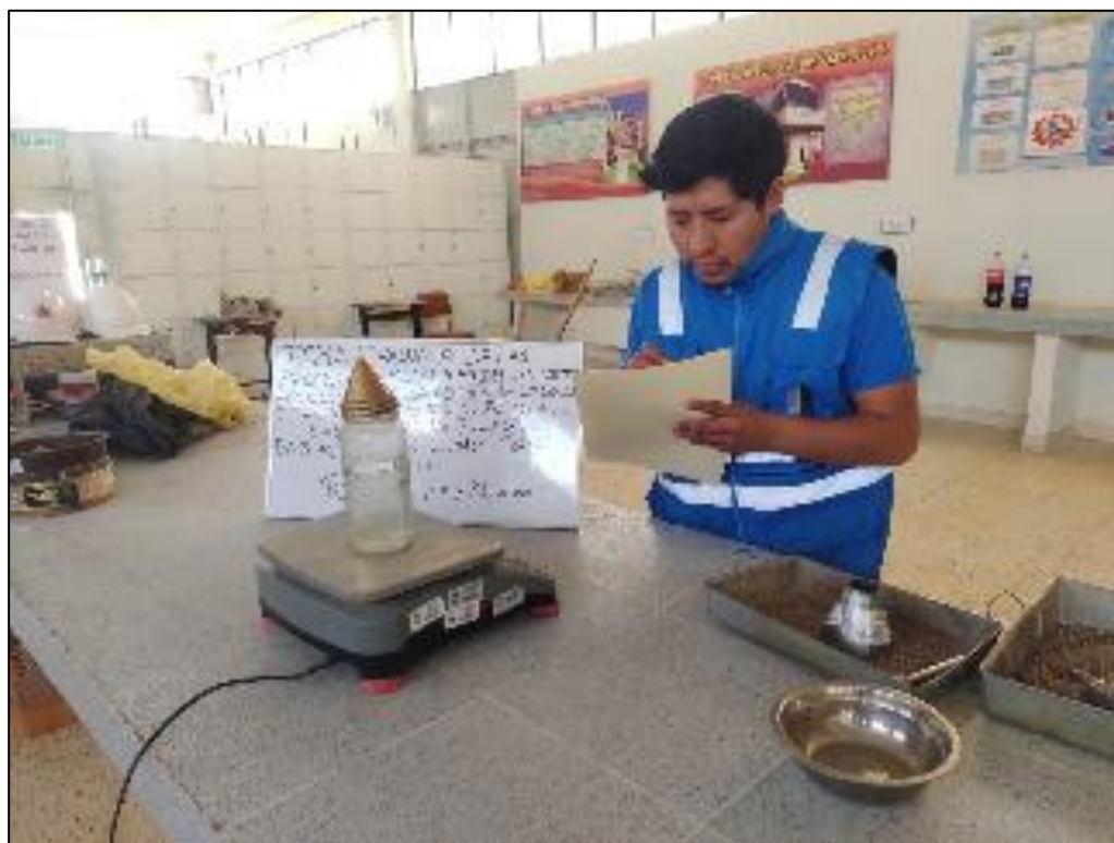
Fotografía 11. Peso del picnómetro para determinar la densidad de líquidos y sólidos.
