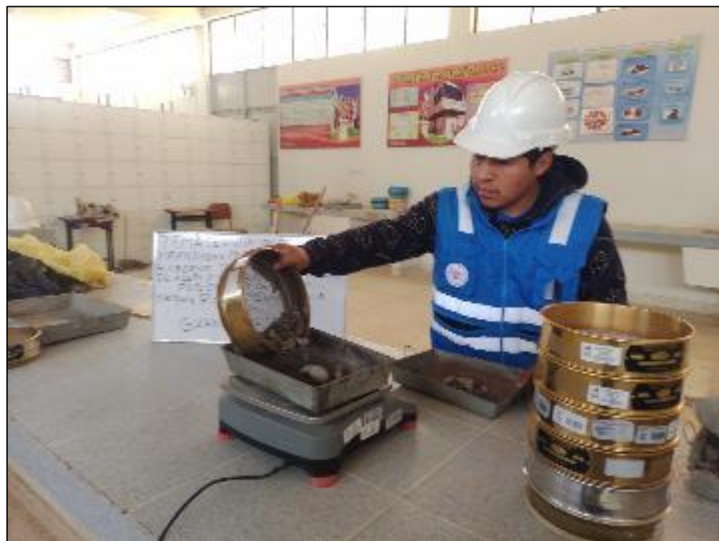
Fotografía 6. Peso de la separación del agregado fino y grueso por el tamiz N° 4.
