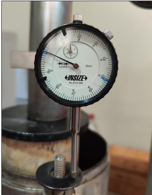
Figura 8 Dial analógico con aproximación 0.01mm.
