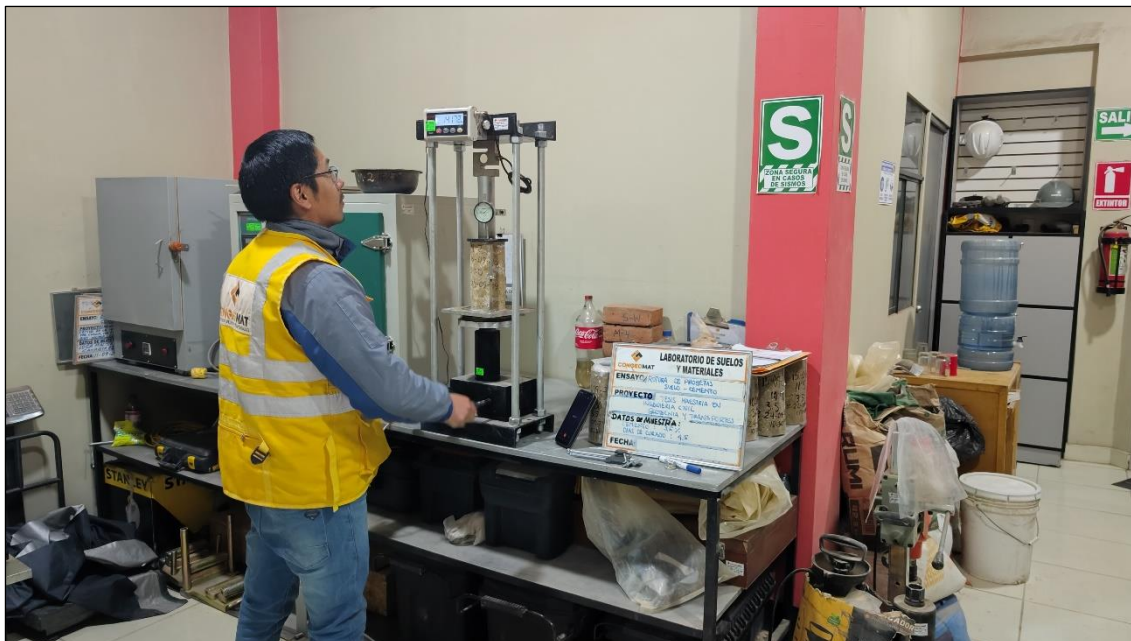
Figura 9 Rotura de probetas de suelo-cemento.
