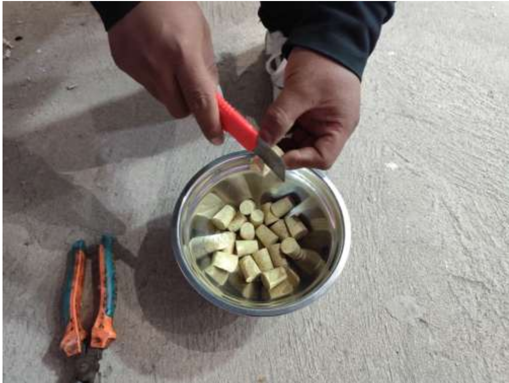
Fotografía 1. Obtención del corcho reciclado de las botellas de vino
