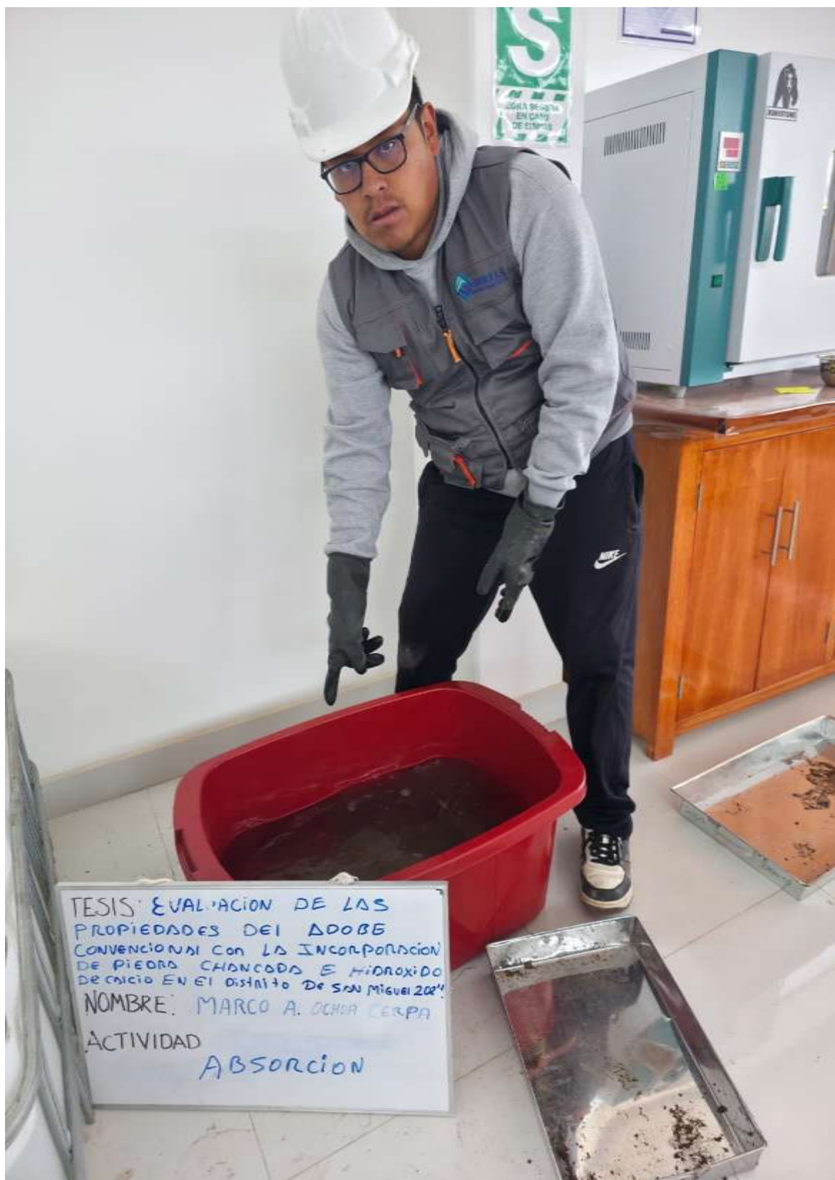
Fotografía 10. Absorción del adobe
