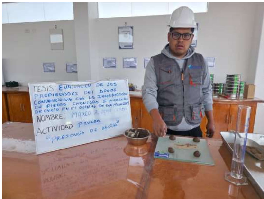
Fotografía 4. Presencia de arcillas
