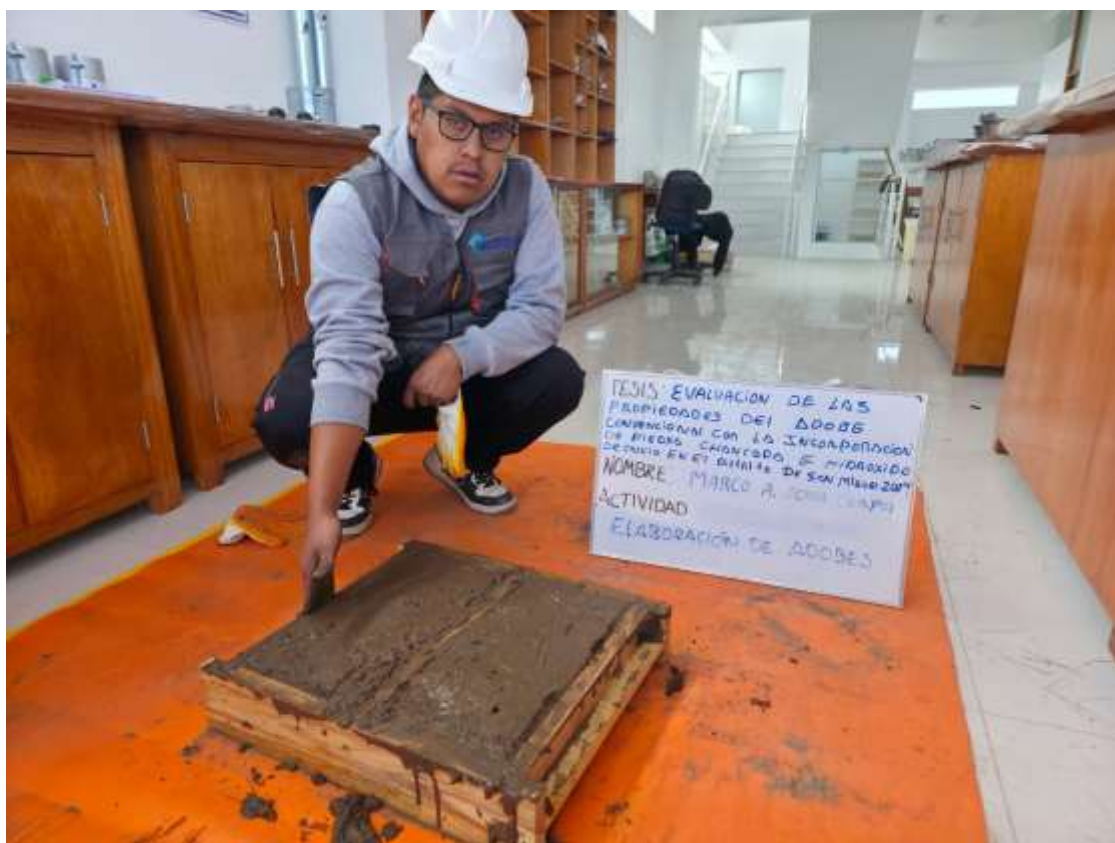
Fotografía 7. Moldeo del adobe
