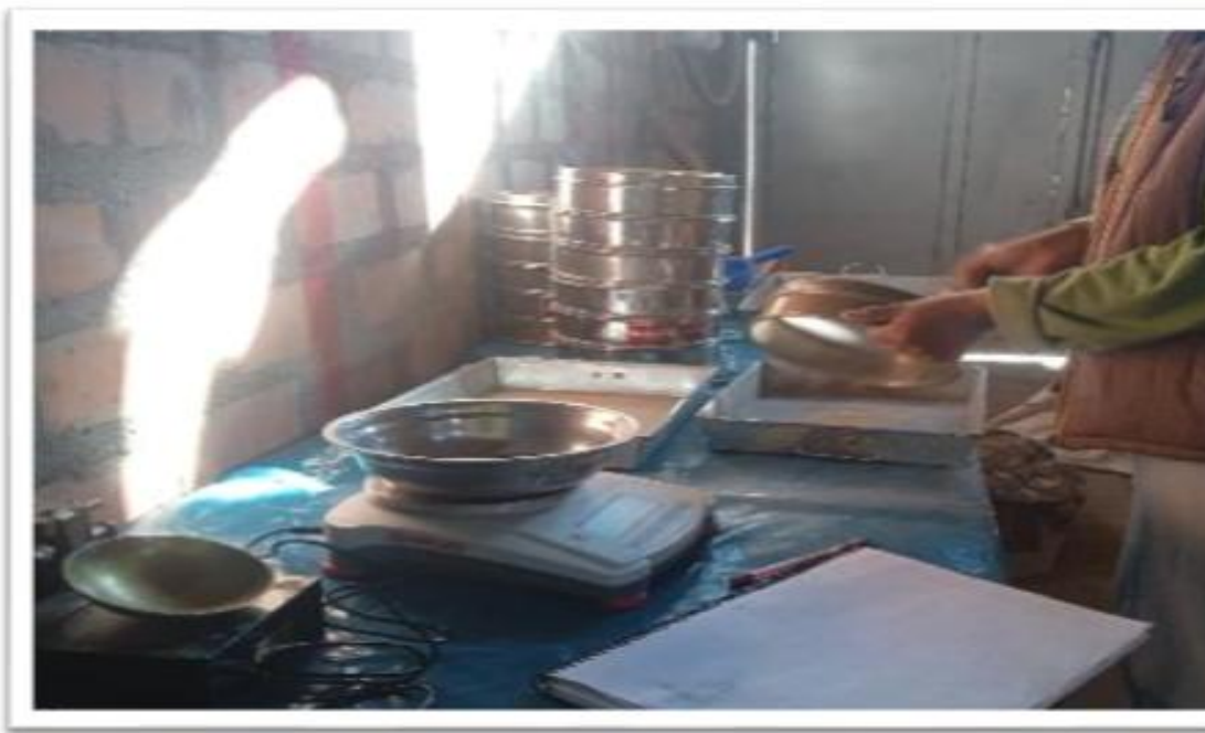
Fotografía N°04: Realización del Ensayo de Granulometría, de acuerdo a la normativa ASTM D 422.
