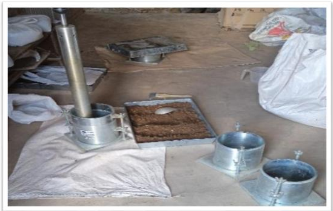
Fotografía N°02: Realización del ensayo de Compactación Proctor Modificado de acuerdo a la normativa ASTM D 1557.
