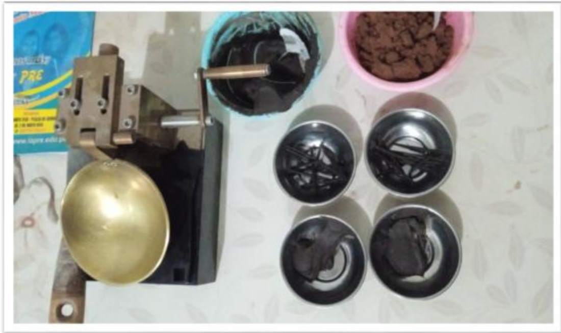
Fotografía N°01: realización del ensayo de límite líquido, de acuerdo a la normativa ASTM D 4318.
