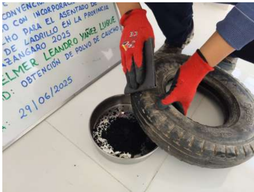
Fotografía 3. Obtención de polvo de caucho.
