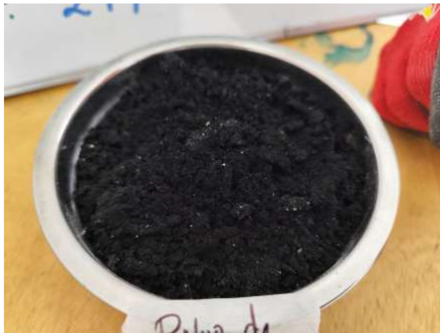
Fotografía 6. Polvo de caucho tamizado por malla N° 200.
