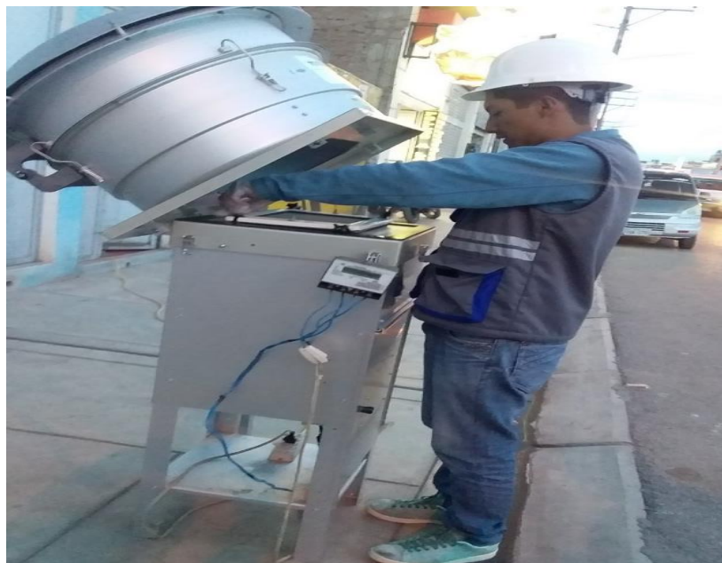
Figura 6: Colocación del filtro
