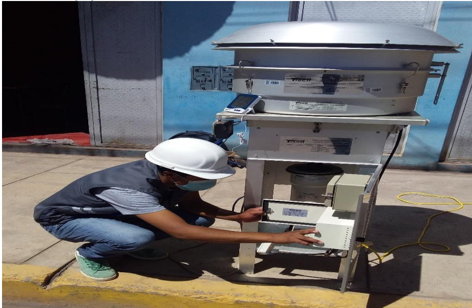
Figura 5: Instalación del equipo Hi - Vol
