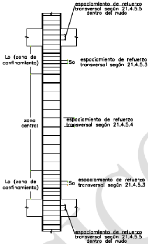
Fig. 21.4.5 Requerimientos de estribos en columnas
