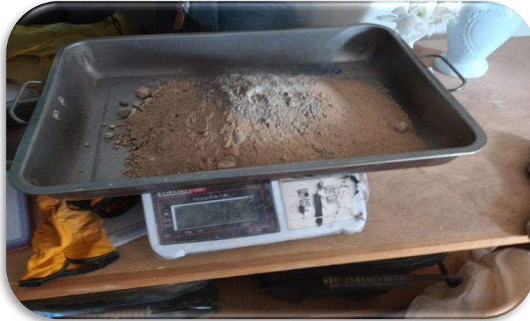
FOTOGRAFÍA 13: ADICIÓN DE CEMENTO A LA MUESTRA PATRON
