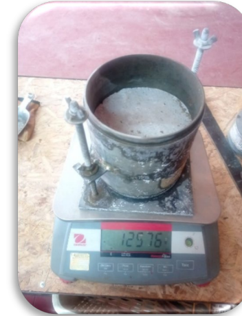
FOTOGRAFÍA 18: ENSAYO DE CBR DE LABORATORIO
