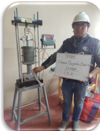
FOTOGRAFÍA 11: ENSAYO DE CBR DE LABORATORIO
