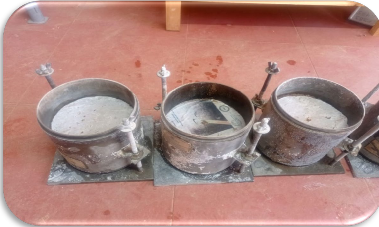
FOTOGRAFÍA 17: ENSAYO DE CBR DE LABORATORIO
