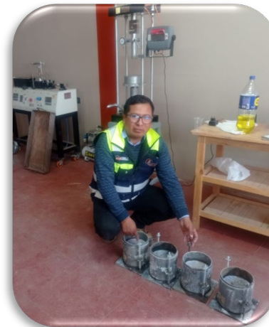
FOTOGRAFÍA 12: ENSAYO DE CBR DE LABORATORIO
