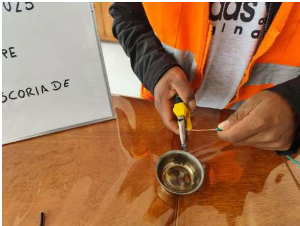
Fotografía 3. Corte del cobre en partículas diminutas.
