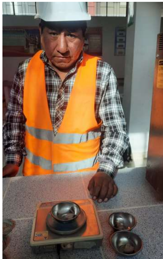
Fotografía N° 04: Pesado de muestra de límite líquido
