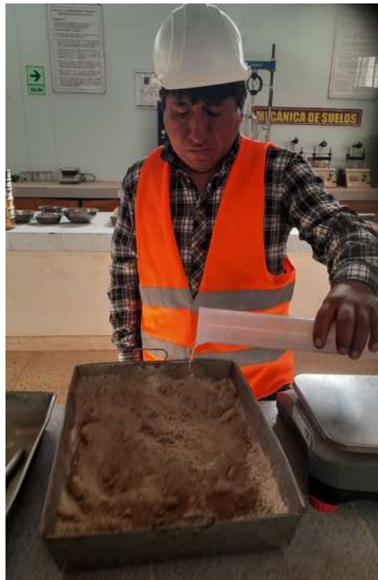
Fotografía N° 10: Combinación del agua con la muestra
