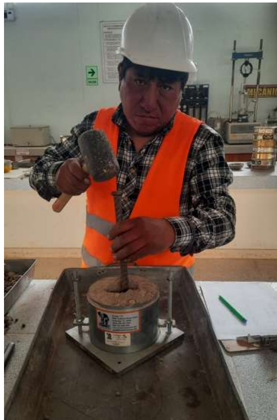
Fotografía N° 16: Extracción de muestra representativa de la parte superior de la muestra compactada del ensayo Proctor
