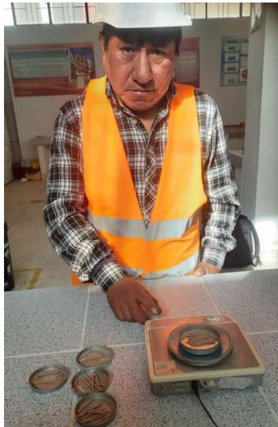
Fotografía N° 06: Pesado de muestra de límite plástico
