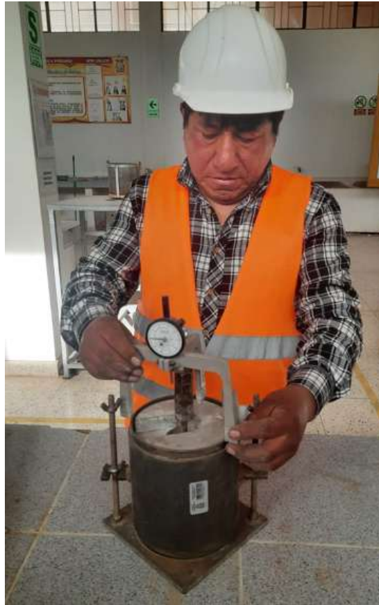
Fotografía N° 21: Colocación de vástago de CBR para medición de expansión y penetración
