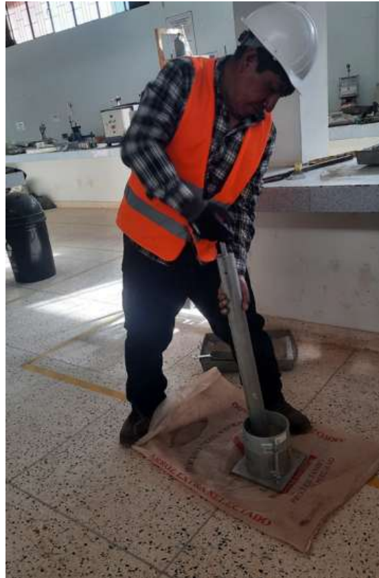
Fotografía N° 16: Extracción de muestra representativa de la parte superior de la muestra compactada del ensayo Proctor
