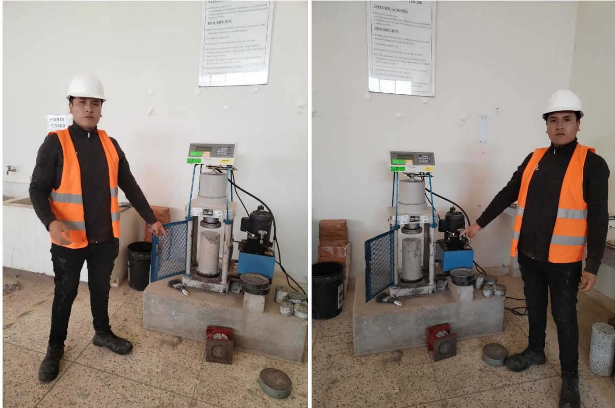
Fotografía 7. Rotura de briquetas
