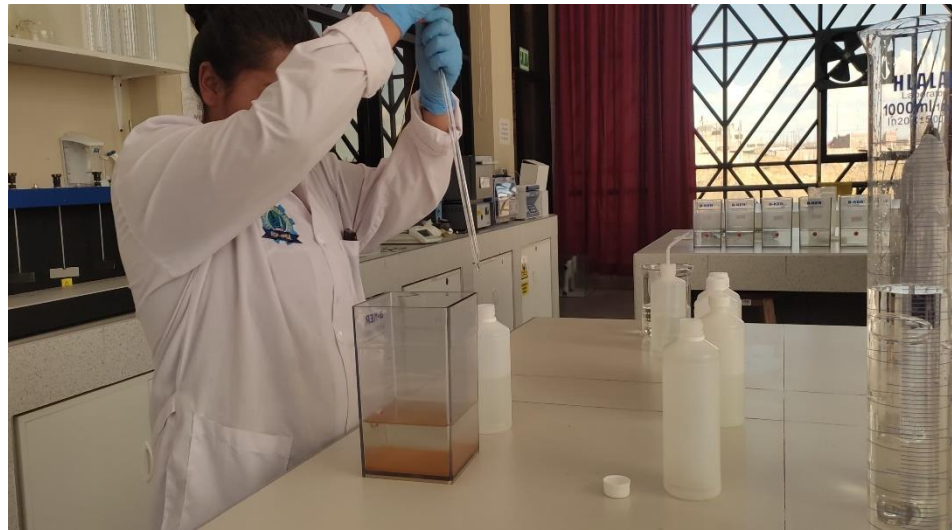
Fotografía 2: Forma de aplicar la dosis de cloruro férrico en la prueba de jarras
