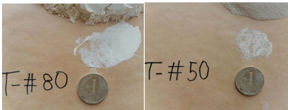
Diferencia de tamaño de partícula empleada para la remoción de Hg en la prueba de jarras.
