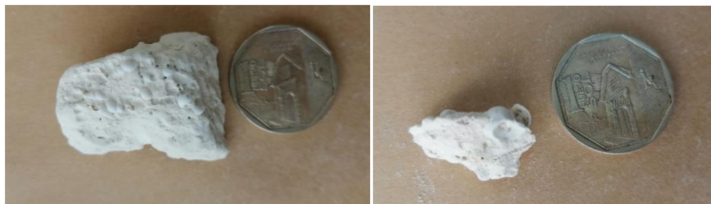
Parte de las muestras compuestas del material zeolítico muestreado del C.P. de Lluno. Notándose la presencia de esqueletos minerales compuestos de \text{CaCO}_3 .
