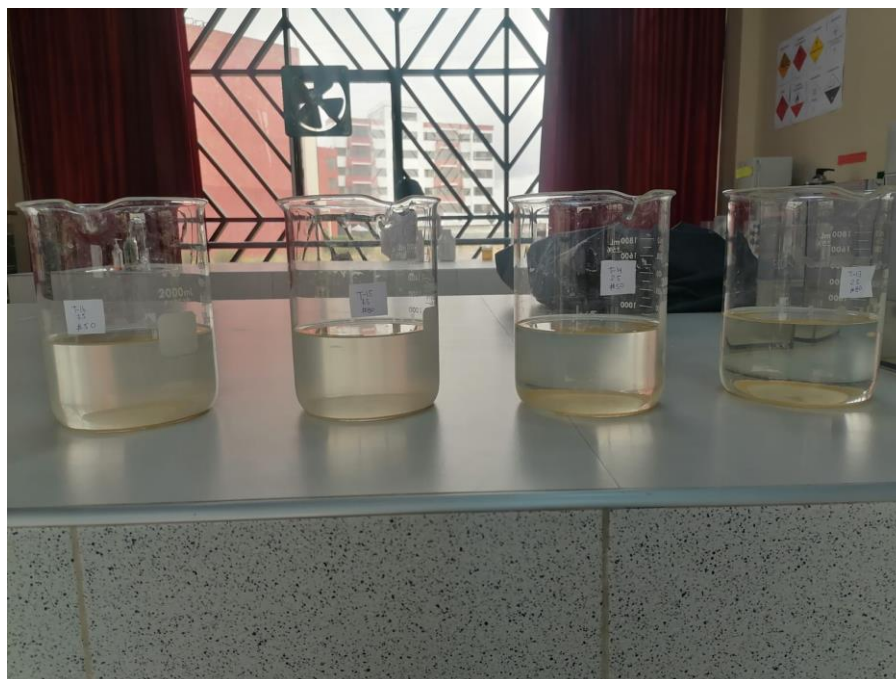
Diferencia entre los tratamientos T-13, T-14 (acondicionamiento a un medio ácido), T-15 y T-16 (acondicionamiento a un medio neutro); después de 18 Hrs. de haber realizado el proceso de remoción de mercurio.
