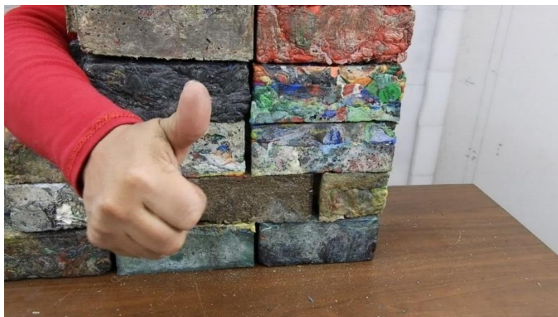
Figura 9 Ladrillo de plástico fundido.
